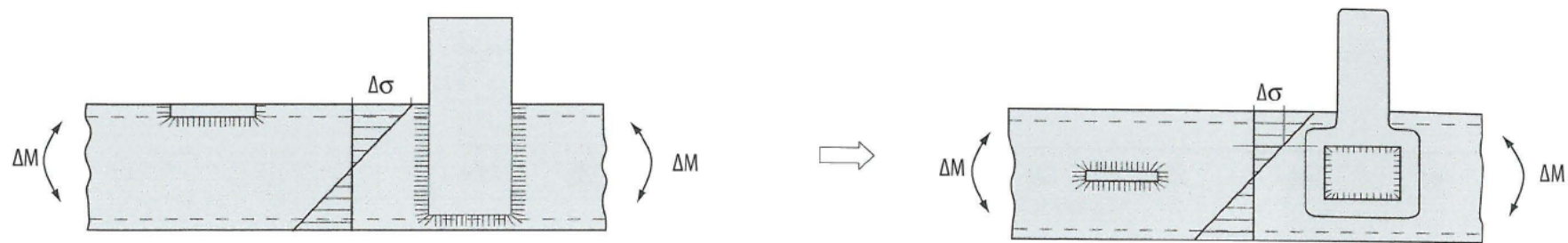
Figur 5.22: Svetsa lastinföringar i balkar nära neutralaxeln
