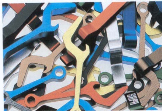
Flasköppnare. Gradtrumling, kortlängds-anodisering, screentryck.
