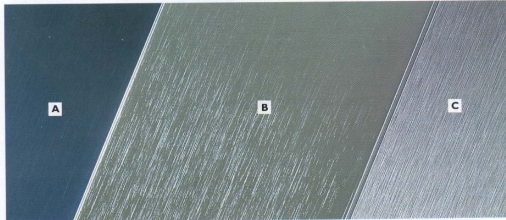
Slipade ytor. A: "mycket fin". B: "medium". C: "grov".
