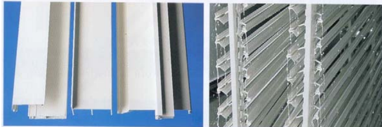
Bild 1 och 2. HM-vit i praktiken. Bild 3. Infärgade profiler på väg upp ur processbadet.
