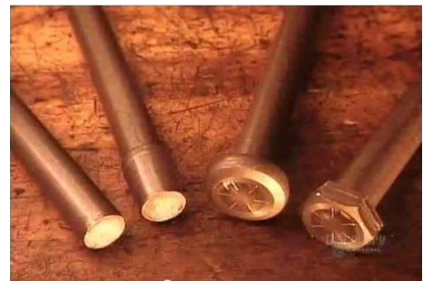
Figur 4. Steg för steg över hur ett skruvhuvud blir till.
