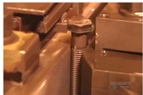
Figur 5. Gängorna trycks in på skruvarna med väldigt högt tryck.
